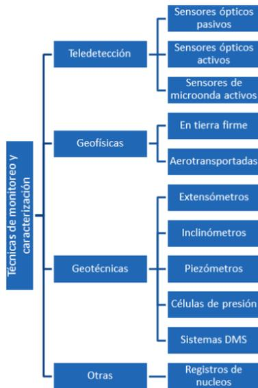
Figura 1. Investigación de deslizamientos a través de métodos geofísicos y técnicas de monitoreo (Vázquez, 2013).
